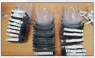
Imprimé en 3D, le support est flexible et imprime le contour de la tête. L'élastique à longueur modulable permet de fixer le support. Une visière en PET est clipsée sur le support, et protège l'utilisateur des projections. Ce matériel vient en complément du masque de protection.
